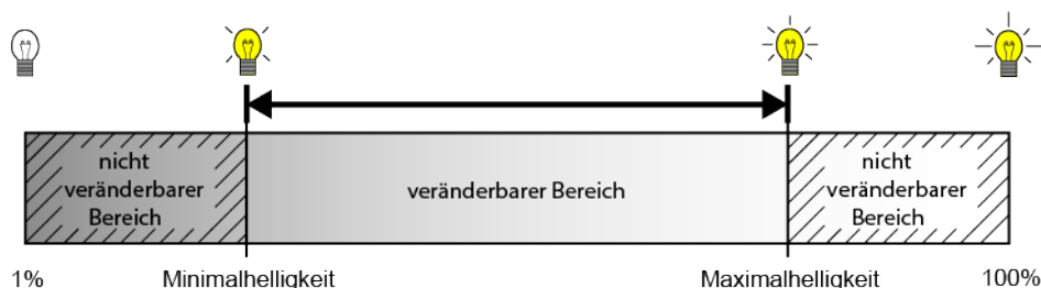
Bild 40: Helligkeitsverlauf beim automatischen Helligkeitsdurchlauf
